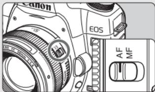
**Set the lens focus mode switch to <AF>.** (p.31)
